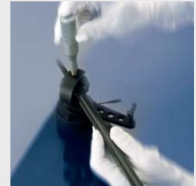
Justage des Kardanlagers eines Tonarms
